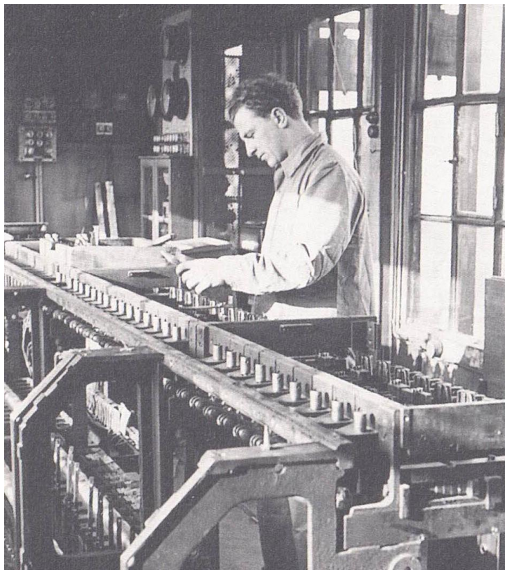
Ernst Dewath 1946 beim Zusammenbau eines Stellwerksapparates
